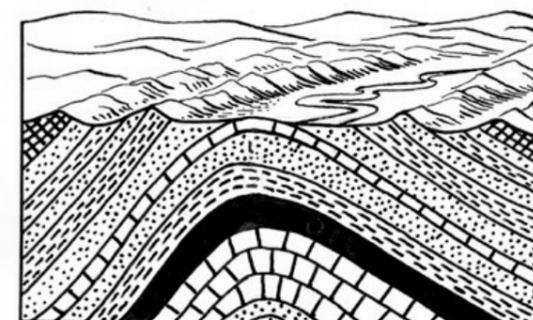
**Fig. 5.1** - Esquema de um relevo invertido de uma antiforma pela erosão de um rio, como é o exemplo do rio Ferreira no Parque das Serras do Porto ([https://commons.wikimedia.org/wiki/File:Anticline\\_\(PSF\)-vector.svg](https://commons.wikimedia.org/wiki/File:Anticline_(PSF)-vector.svg))
