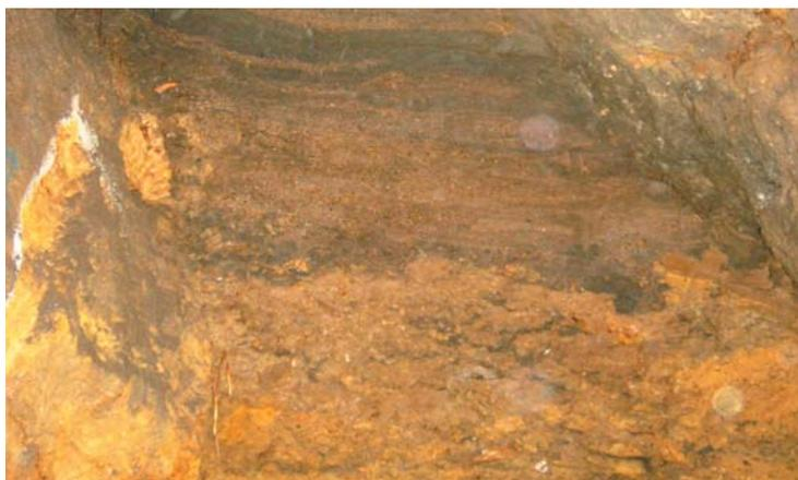
**Figura 16.** Colmatação de desmorte mineiro subterrâneo, com fracção grosseira em baixo e fina por cima, em Castromil.
