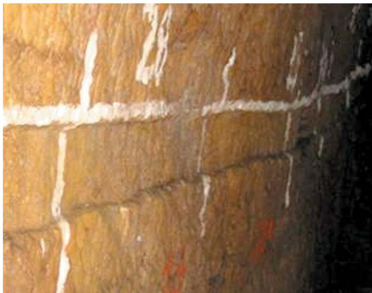
**Figura 21.** Amostragem em Canal, em Castromil.
