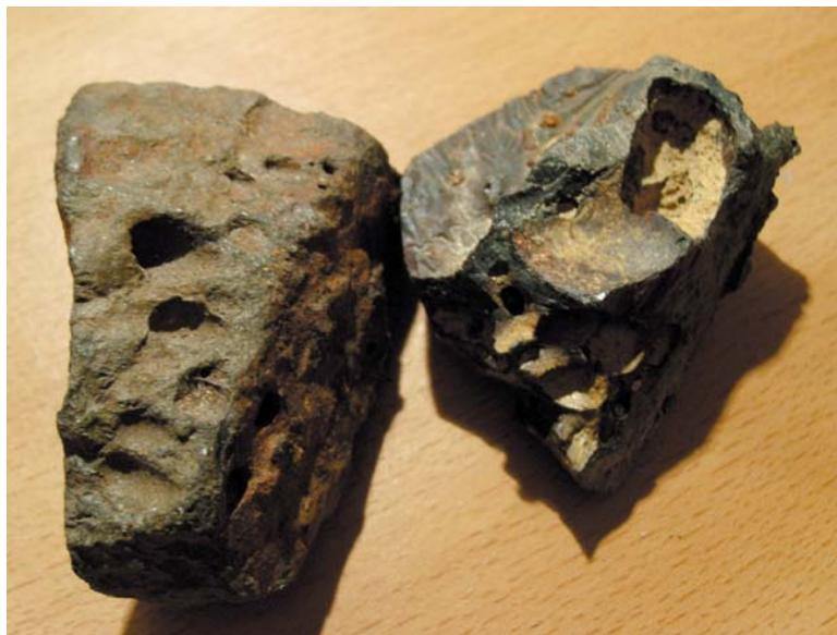
Figura 18. Escórias siliciosas, ricas em vesículas, encontradas em Castromil.
