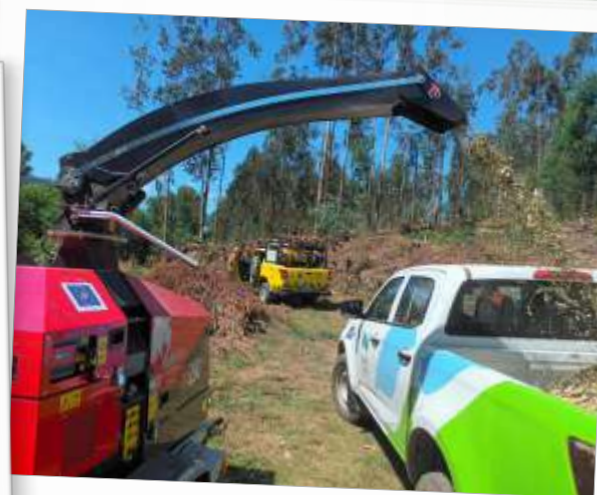
investimento Lipor recurso a bio triturador para produzir estilha, utilizada para cobertura de solo [mulching]
